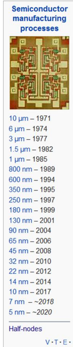
Şekil 3.7.11.3. CMOS teknolojisinde boyut küçülmesi
